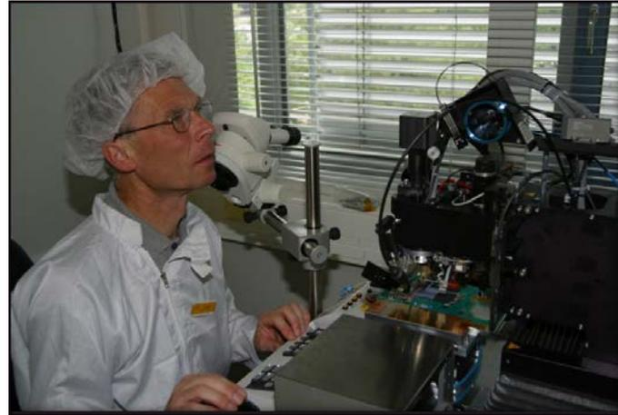
Bau von Siliziumstreifendetektoren in Freiburg (2005) zur Vermessung der Spurpunkte (→ Impuls) von elektrisch geladenen Teilchen
